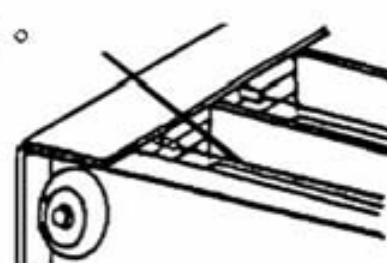
(e) 清洗後，請用水將集塵器上的洗淨液及塵埃沖洗乾淨。
