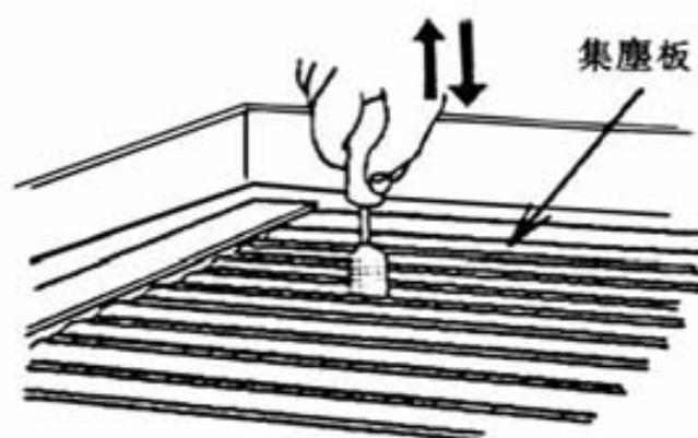
(f) 清洗後的集塵器，請放置在平台上，讓其自然乾燥(約 12 小時以上)。確保集塵器上，沒有殘留水滴完全乾燥，再行安裝。
