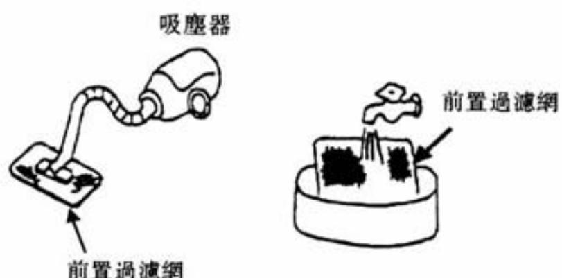
(c) 用水清洗的情況，請務必待濾網完全乾燥後再裝回。
