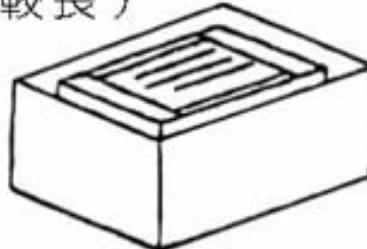
(d) 請使用軟性的布，清洗集塵器的離子化線上的塵埃。
