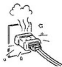
**2** 電源線有無破裂或損傷？
