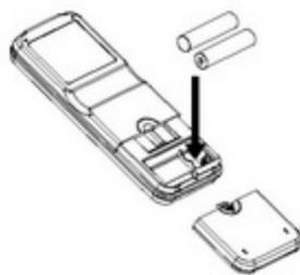
請輕壓遙控器背面蓋子上的“▽”，將蓋子往下推出，即可進行電池的更換。
