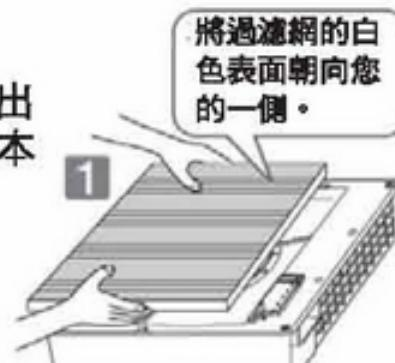
● 安裝過濾網，使過濾網側面上的「手前側」字樣朝向面板。
