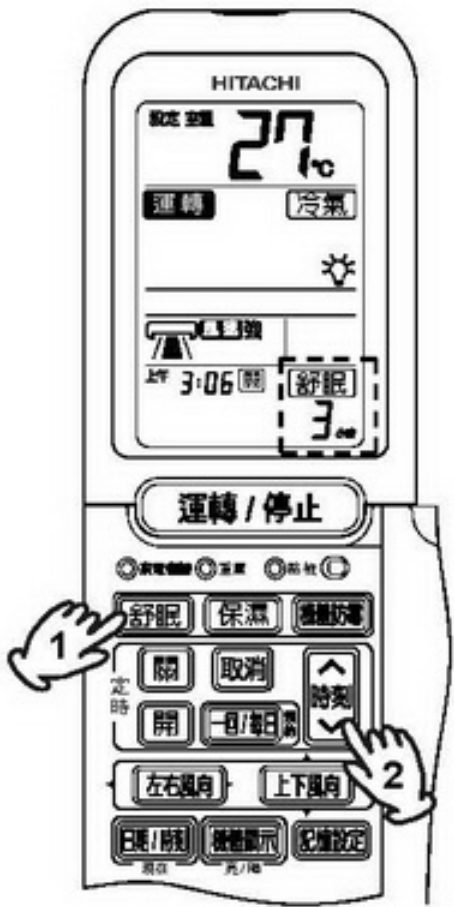
★ 上圖表示為在上午 0:06 開始舒眠運轉 3 小時後，於上午 3:06 時關機之設定。
