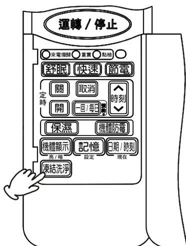
■ 此功能可有效清潔室內機內部熱交換器的灰塵、黴菌、油污等物質，但無法完全去除。
