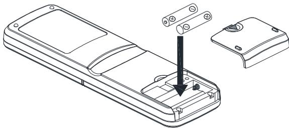
請輕壓遙控器背面蓋子上的“▽”，將蓋子往下推出，即可進行電池的更換。
