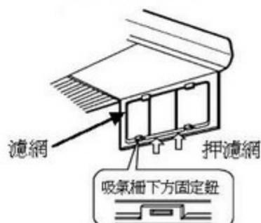
3. 把濾網朝上推, 讓濾網成弓字形狀, 使其從吸氣柵的固定鈕卸下, 然後再向前拉, 即可取下濾網。
