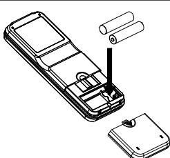
請輕壓遙控器背面蓋子上的 " "，將蓋子往下推出，即可進行電池的更換。
