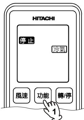
**2** 於設定模式中，每按一下 **功能** 鍵，切換冷暖/冷專型，當顯示 5 種功能時表示為冷暖型，3 種為冷專型。
