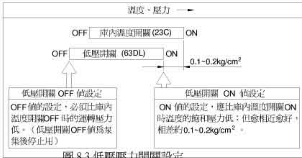
圖 8.3 低壓壓力開關設定
